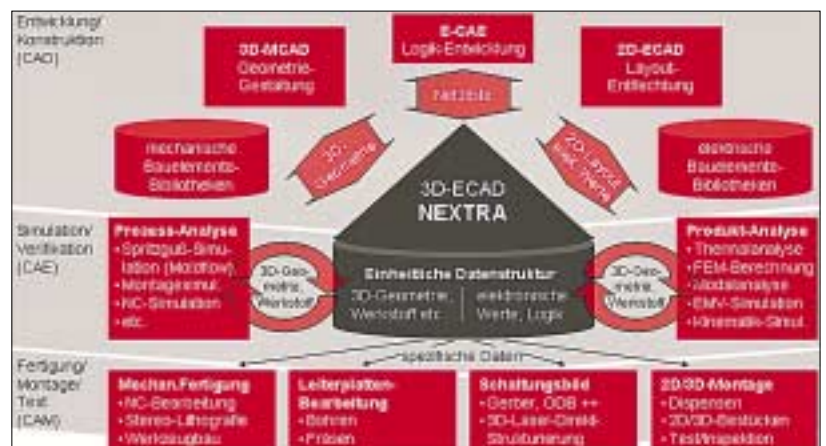
Bild 5. NEXTRA kann in laufenden Entwicklungsprozessen zum Einsatz kommen, da sich die Software nahtlos in führende E- und MCAD-Programme integrieren lässt. Die Anbindung an die EDA-Systeme von Mentor Graphics, Cadence und Zuken erfolgt über Schnittstellen für Netzliste, Bibliotheken, Autorouter, Autoplacer und 2D-Layout-Systeme.
