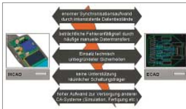
Bild 2. Schwachstellen des konventionellen elektro-mechanischen Konstruktionsprozesses.
