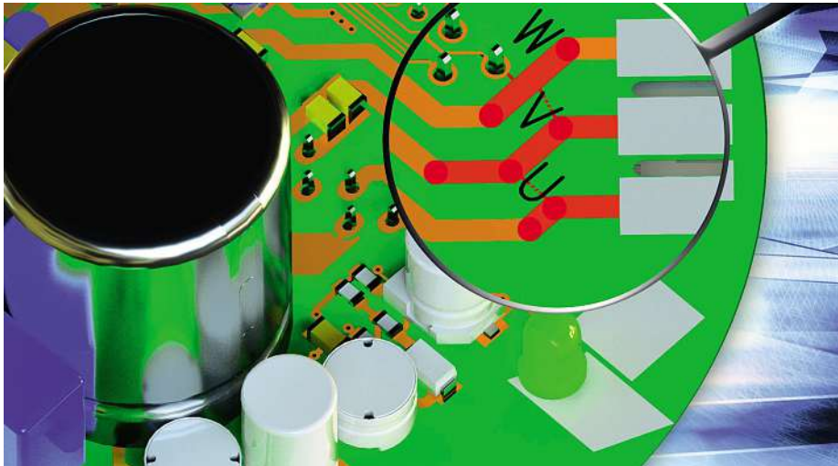
Bild 2: Simulation einer Kriechstrecken-Verletzung bei 5400 m über Meeresspiegel.
